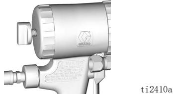
13. 在纸板上检验喷涂效果。调节空气调节器以获得具有良好喷型的最小流体压力。
