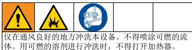
仅在通风良好的地方冲洗本设备。不得喷涂可燃的流体。用可燃的溶剂进行冲洗时，不得打开加热器。
