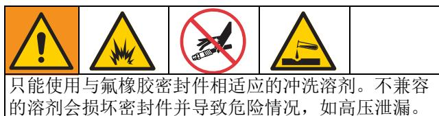
只能使用与氟橡胶密封件相适应的冲洗溶剂。不兼容的溶剂会损坏密封件并导致危险情况，如高压泄漏。
