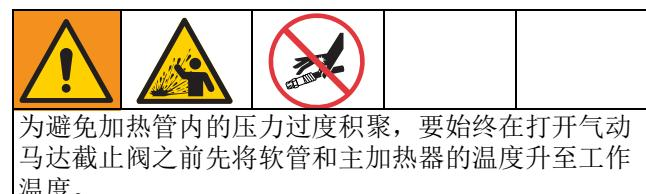
为避免加热管内的压力过度积聚，要始终在打开气动马达截止阀之前先将软管和主加热器的温度升至工作温度。
